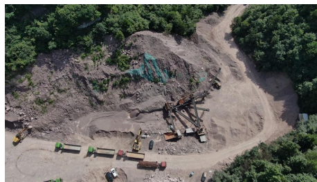
图 3 堆渣体结构松散
