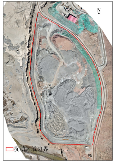
图 5 通过 ArcMap 人工解译并计算 2 号弃渣场扰动面积
